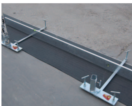
7. A nivelláló készletre helyezett libellás lehúzóléc
